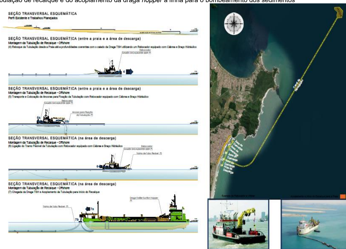
Figura 5 – Imagem extraída do projeto de alimentação artificial da Praia do Gravatá, que ilustra o procedimento de montagem da tubulação de recalque e do acoplamento da draga hopper à linha para o bombeamento dos sedimentos
